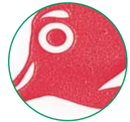
無調整で28,400回印刷後のソフトPEテープ印刷品質
