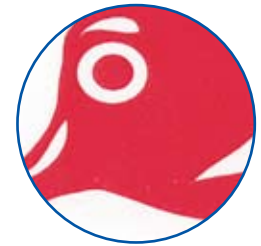
無調整で28,400回の印刷後のR/bak SA 3120テープの印刷品質
