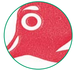
Calidad de impresión de la cinta de PE blanda después de 28.400 impresiones sin ajustes.
