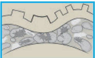
“气球”般闭孔式结构在过度的压力下会破裂
