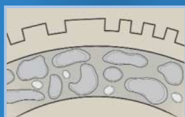
Espuma de polietileno de células fechadas
