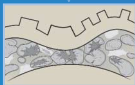
"Balões" ou estrutura de células fechadas rompem-se com o excesso de impressão
