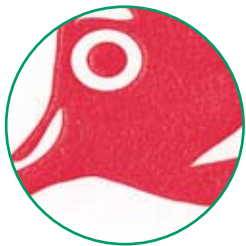
使用普通聚乙烯泡棉胶带的初始印刷质量。
