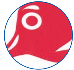
不加调整地进行28400次压印后的R/bak SA 3120印刷质量。
