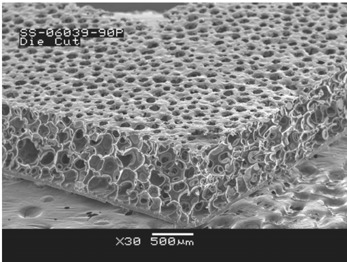
图 5、PORON 4701-15-06039 钢刀加工
