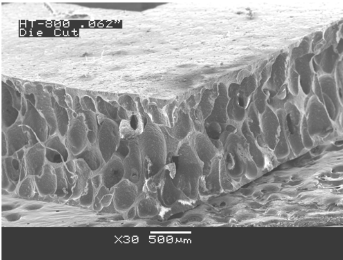
图 8、BISCO HT-800 1.59mm 钢刀加工
