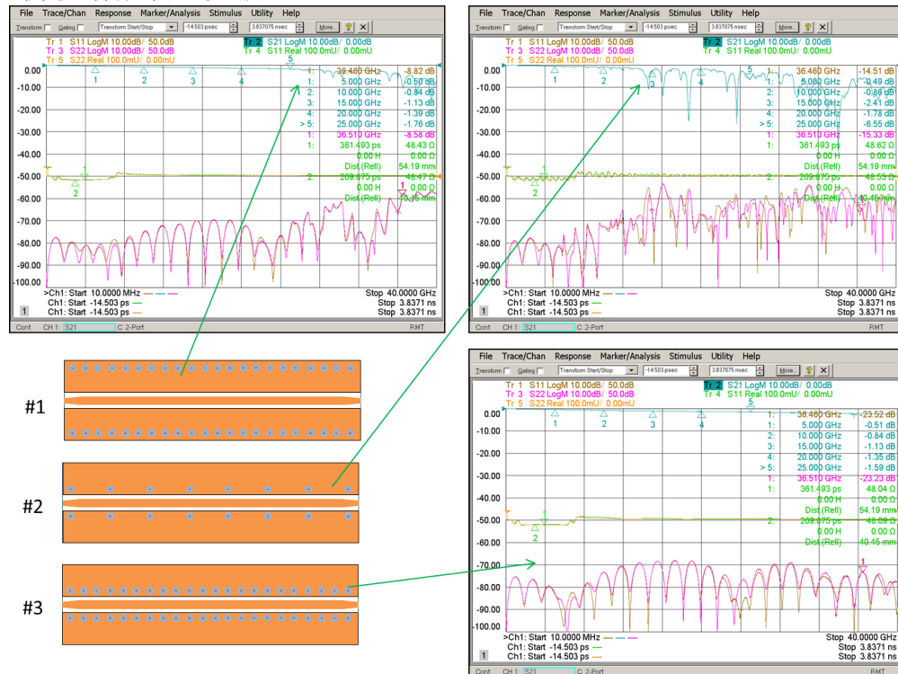
图 7 不同接地过孔位置的 GCPW 性能比较
